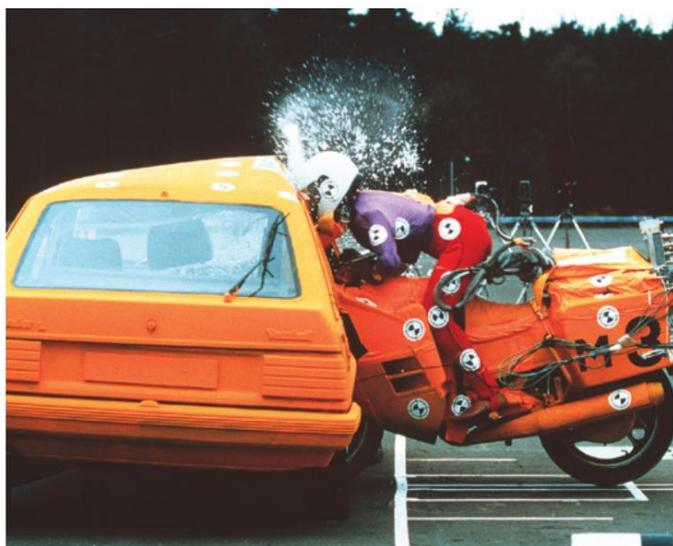
Figura 4-31 La posición de un motociclista es por encima del punto de giro de la rueda delantera cuando la motocicleta impacta un objeto de frente.
