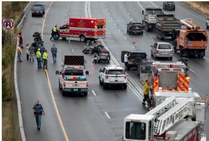
Figura 5-4 El posicionamiento correcto de un vehículo de emergencia.
