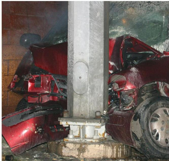
**Figura 4-13** Cuando un vehículo impacta un poste de servicios públicos, la parte delantera del automóvil se detiene, pero la parte trasera del vehículo continúa avanzando, provocando la deformación del vehículo.
